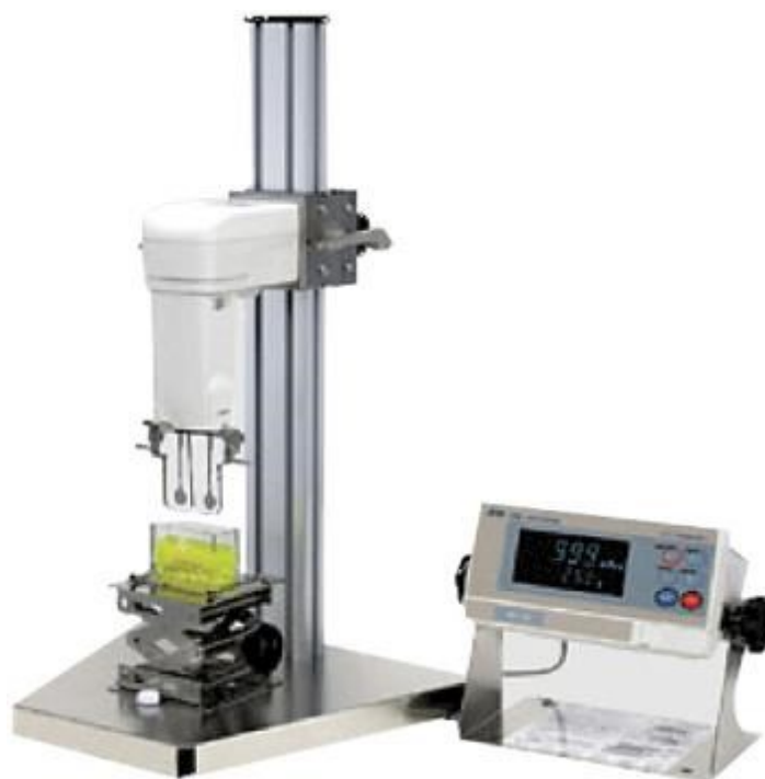
Рисунок 2.6. – Вибрационный вискозиметр SV-10
