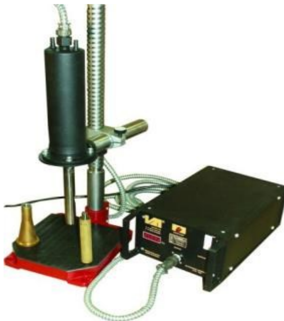
Рисунок 2.8 - Лабораторная ультразвуковая установка ИЛ100-6/1
