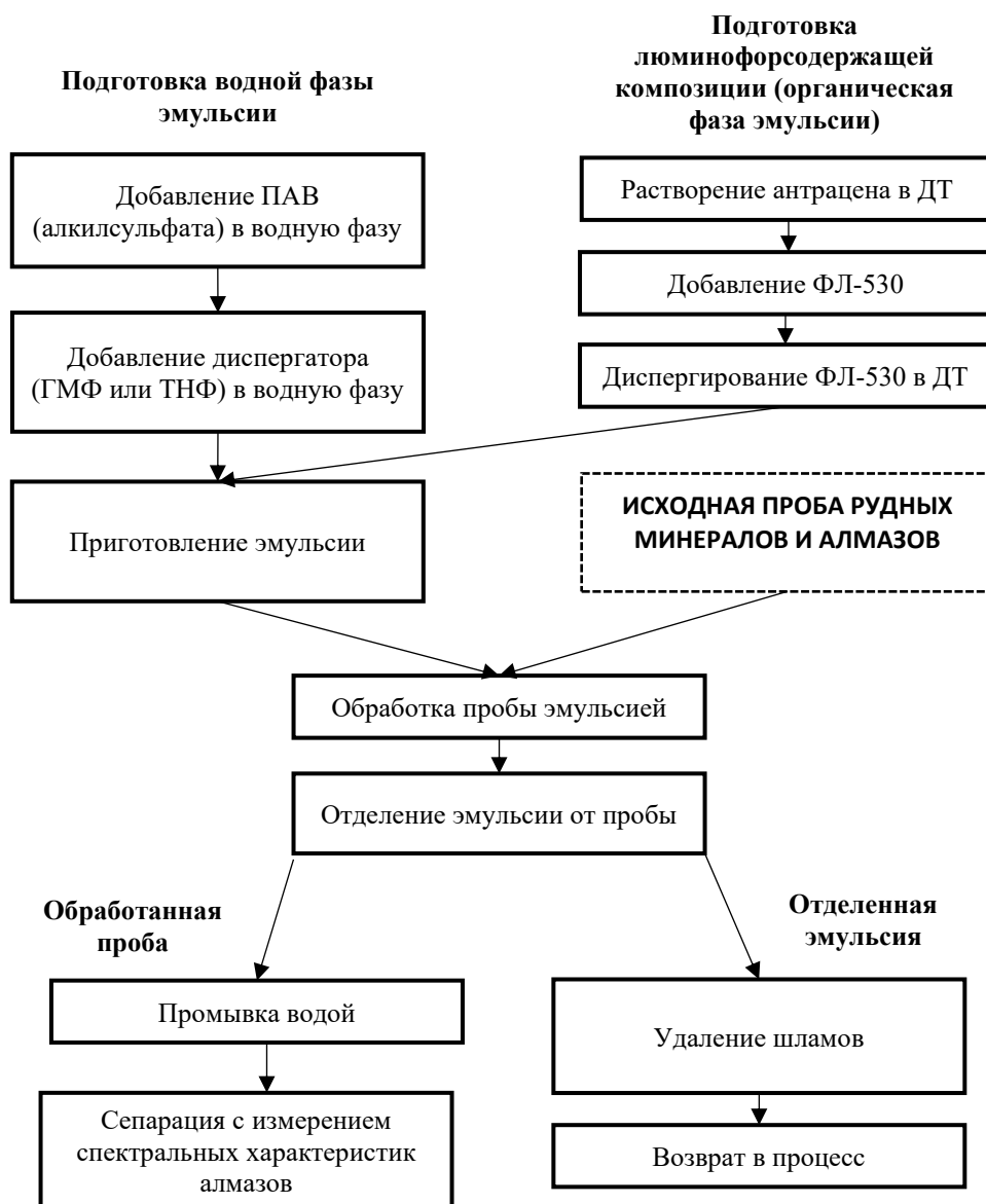
Рисунок 4.14 - Принципиальная схема проведения эксперимента по модифицированию спектральных характеристик алмазов
