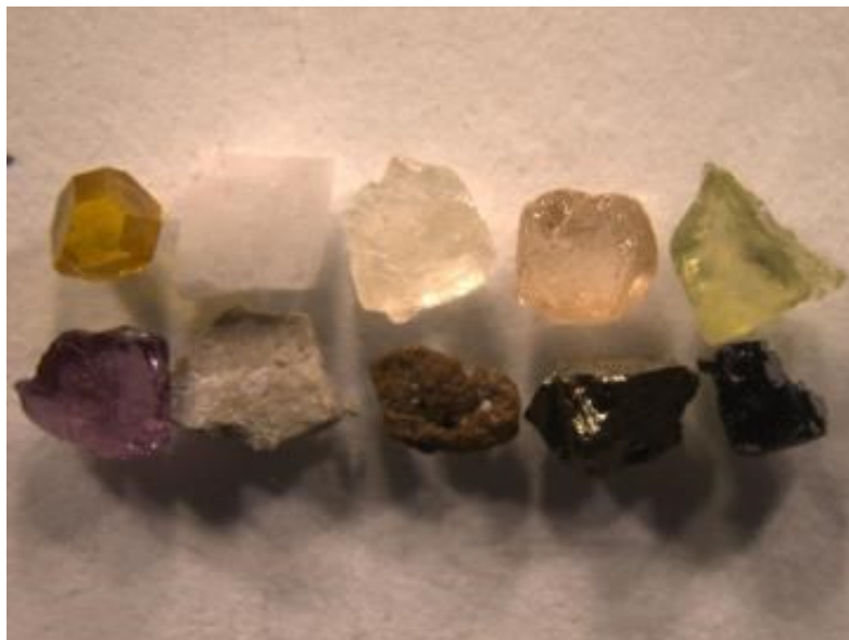
Рисунок 4.15 - Внешний вид минералов, используемых при проведении исследований. Верхний ряд слева-направо: 1 - алмаз с аномальной светимостью; 2 - магнезиальный ильменит; 3 – флогопит; 4 – циркон; 5 – оливин. Нижний ряд слева-направо: 6 - пироп; 7 – лейкократовая порода; 8 – меланократовая порода; 9 – халькопирит; 10 – пирит.
